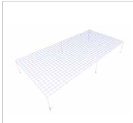
Modelovanie s použitím prúťových prvkov - nedeformovaný tvar.
